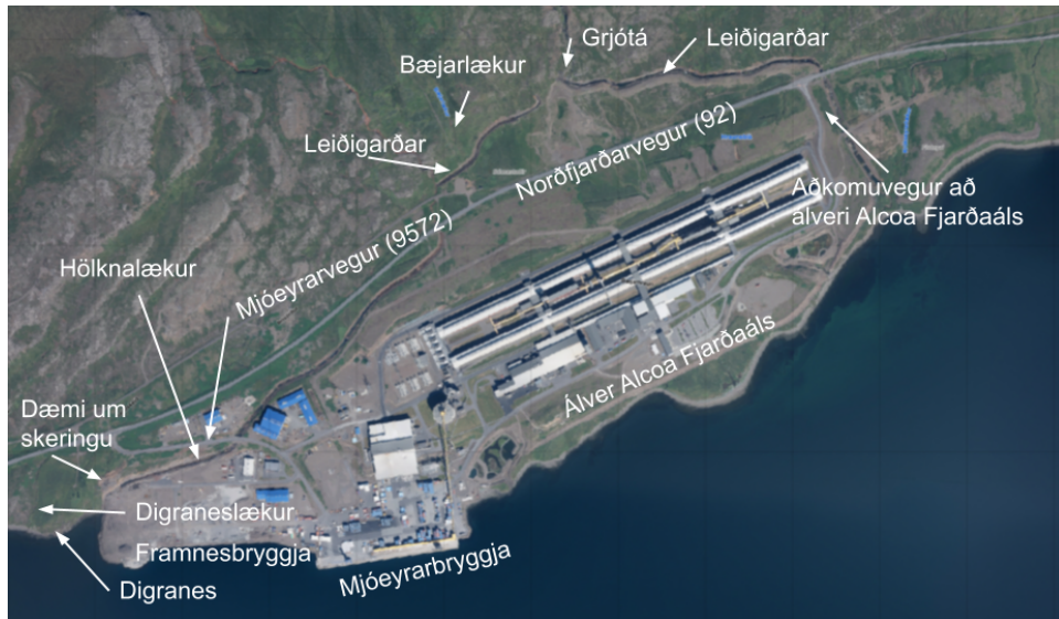
Mynd 3.2 sýnir hafnar- og iðnaðarsvæði Mjóeyrarhafnar, aðkomuvegina Norðfjarðarveg (92) og Mjóeyrarveg (9572), sem eru stofnvegir, helstu ár og læki sem renna um deiliskipulagssvæðið, auk leiðigarða sem komið hefur verið upp í brekku norðan við Mjóeyrarveg. Loftmyndin er frá 2019. Lengst til vinstri á hafnarsvæðinu, sést dæmi um skeringu í berggrunn, þaðan sem efni hefur verið nýtt til uppbyggingar hafnarsvæðisins. Þarna sést einnig hvernig hafnarsvæðið er mótað inn í berggrunninn. Ávinningur er skýr. Hafnarsvæðið verður samfelld með litlum halla og því aðgengilegt til athafna, en samhliða fæst gott efni úr berggrunninum sem nýtilegt er til framkvæmda m.a. við þróun og stækkun hafnarinnar.
