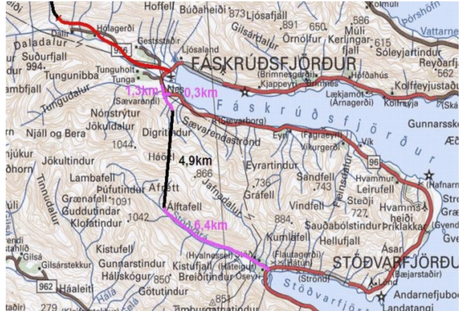
Mynd 23. Jarðgöng milli Fáskrúðafjarðar og Stöðvarfjarðar
